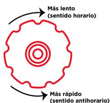
La amortiguación de rebote permite controlar la velocidad a la que el amortiguador vuelve después de ser comprimido. El valor de rebote adecuado es una cuestión de preferencia personal y varía dependiendo del peso, del estilo de conducción del ciclista y de las condiciones en que se va a utilizar la bicicleta. La regla práctica es que el rebote sea lo más rápido posible, pero sin que el retroceso llegue a ser tan fuerte que empuje al ciclista fuera del sillín.
