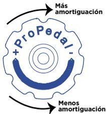
El mando de ajuste de ProPedal permite al ciclista ajustar la cantidad de amortiguación de ProPedal. La amortiguación ProPedal afecta a la primera parte de la carrera de suspensión y está diseñada para reducir el cabeceo de la suspensión provocado por el pedaleo. Como los diseños de la suspensión son diferentes, no todas las bicicletas requieren el mismo grado de amortiguación de ProPedal proporcionado por la Boost Valve.
