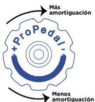
La Boost Valve crea un esquema de amortiguación sensible a la posición que hace posible una transición suave entre una acción eficaz del mecanismo ProPedal y la absorción de baches con ángulos rectos, hasta llegar a una sensación de fin de recorrido en la que no se percibe que el amortiguador toque fondo. Además, la válvula Boost Valve desacopla los ajustes de ProPedal y de tope, permitiendo realizar el ajuste de la plataforma ProPedal independientemente del ajuste de fondo.
